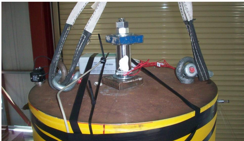
Σχήμα 1.2.20: Αγκύρωση καλωδίου προέντασης στην κορυφή του βάρους ( EA/m_c g=25 ) και διάταξη της δυναμοκυψέλης για την μέτρηση της αξονικής δύναμης επαναφοράς.
