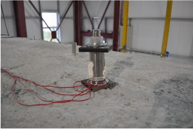
Σχήμα 3.1.5. Αριστερά: Αγκύρωση καλωδίου προέντασης στο πάνω μέρος του καταστρώματος μέσω δυναμοκυψέλης. Δεξιά: Αγκύρωση καλωδίου προέντασης στο κάτω μέρος της σεισμικής τράπεζας μέσω ελατηρίων τύπου belleville springs . Οι φωτογραφίες αντιστοιχούν στην περίπτωση της χαμηλής στάθμης προέντασης \frac{EA}{m_c g} = 50 .
