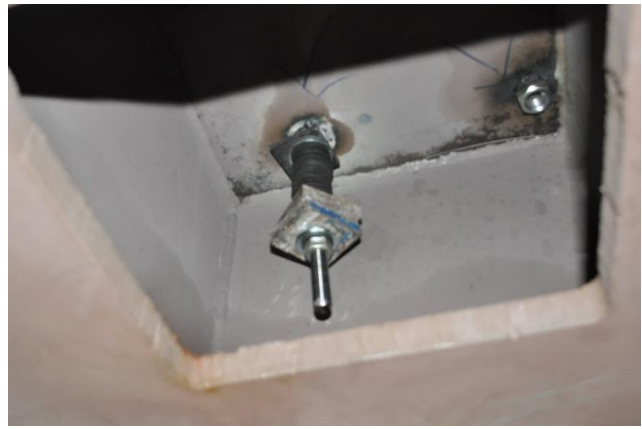
Σχήμα 3.1.5. Αριστερά: Αγκύρωση καλωδίου προέντασης στο πάνω μέρος του καταστρώματος μέσω δυναμοκυψέλης. Δεξιά: Αγκύρωση καλωδίου προέντασης στο κάτω μέρος της σεισμικής τράπεζας μέσω ελατηρίων τύπου belleville springs . Οι φωτογραφίες αντιστοιχούν στην περίπτωση της χαμηλής στάθμης προέντασης \frac{EA}{m_c g} = 50 .
