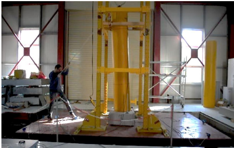
Σχήμα 1.3.1. Δοκιμές ελεύθερης ταλάντωσης ( pull-out, free vibration tests ) βάρου σε μεταλλική βάση ή βάση από οπλισμένο σκυρόδεμα, με δέσμευση της εγκάρσιας μετακίνησης.
