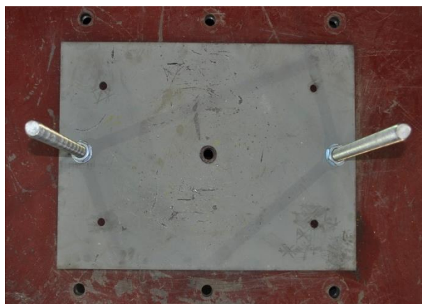
Σχήμα 4.1.6: Μεταλλική βάση έδρασης λικνιζόμενου βάρου αγκυρωμένη στην σεισμική τράπεζα
