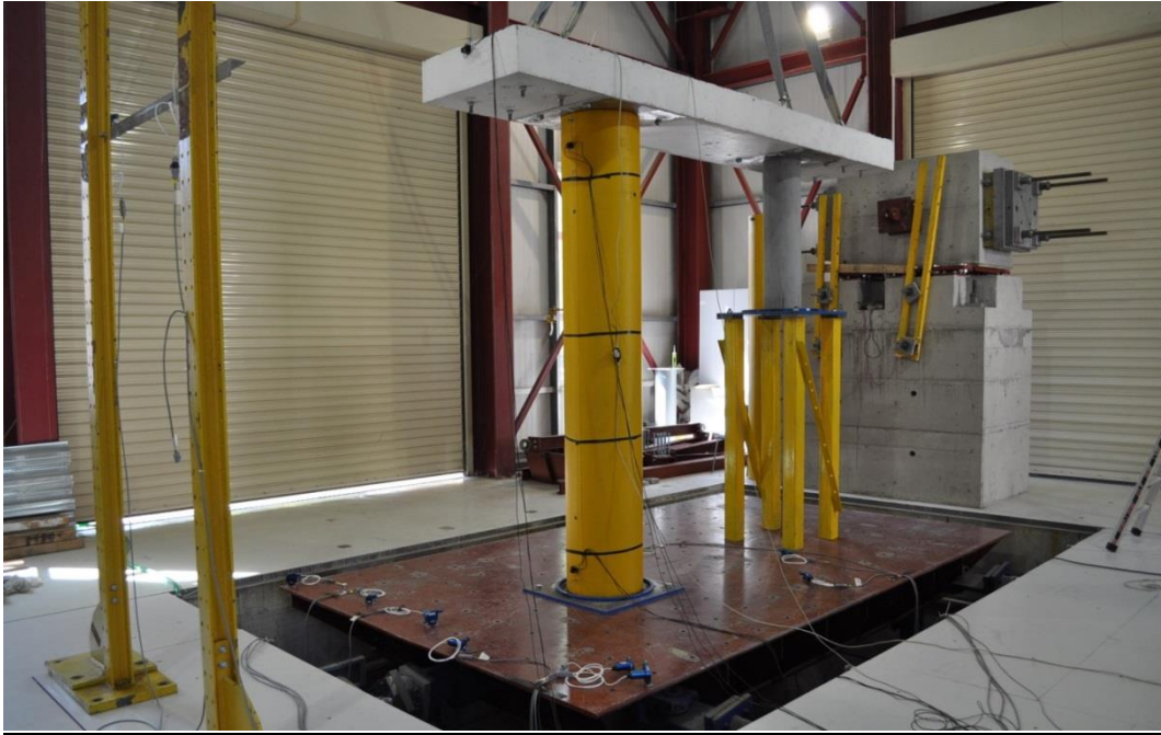
Σχήμα 5.1.3. Πειραματική διάταξη του λικνιζόμενου πλαισίου με ανισοϋπή βάθρα με το μεταλλικό πλαίσιο (αριστερά) και τους αισθητήρες.
