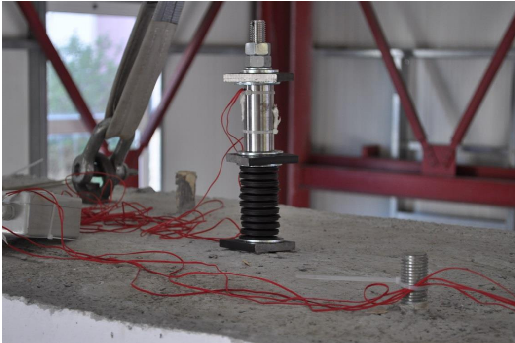
Σχήμα 3.1.6. Αγκύρωση καλωδίου προέντασης στο πάνω μέρος του καταστρώματος μέσω δισκοειδών ελατηρίων και δυναμοκυψέλης για την υψηλή στάθμη προέντασης με \frac{EA}{m_c g} = 150 .
