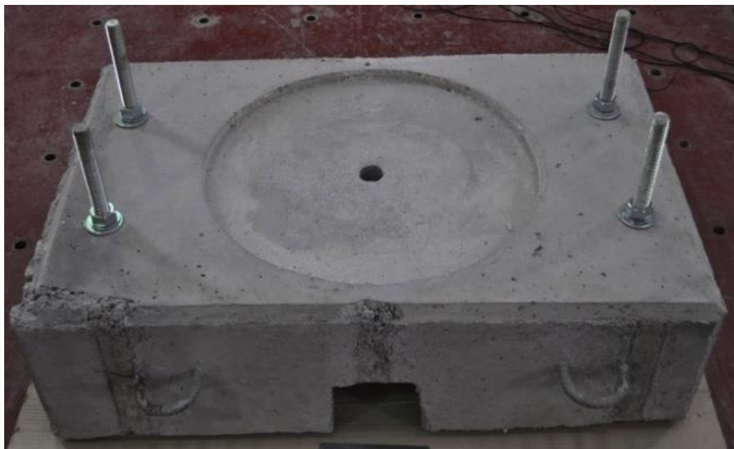
Σχήμα 4.1.3: Βάση έδρασης λικνιζόμενου βάρου από οπλισμένο σκυρόδεμα αγκυρωμένη στην σεισμική τράπεζα
