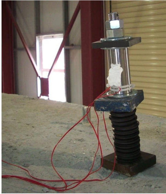
Σχήμα 2.4.6: Αγκύρωση καλωδίου προέντασης στο άνω μέρος του καταστρώματος μέσω ελατηρίων τύπου belleville springs και δυναμοκυψέλης.
