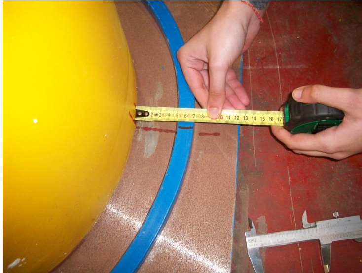
Σχήμα 1.2.18: Μέτρηση της ολίσθησης μετά από κάθε πείραμα.
