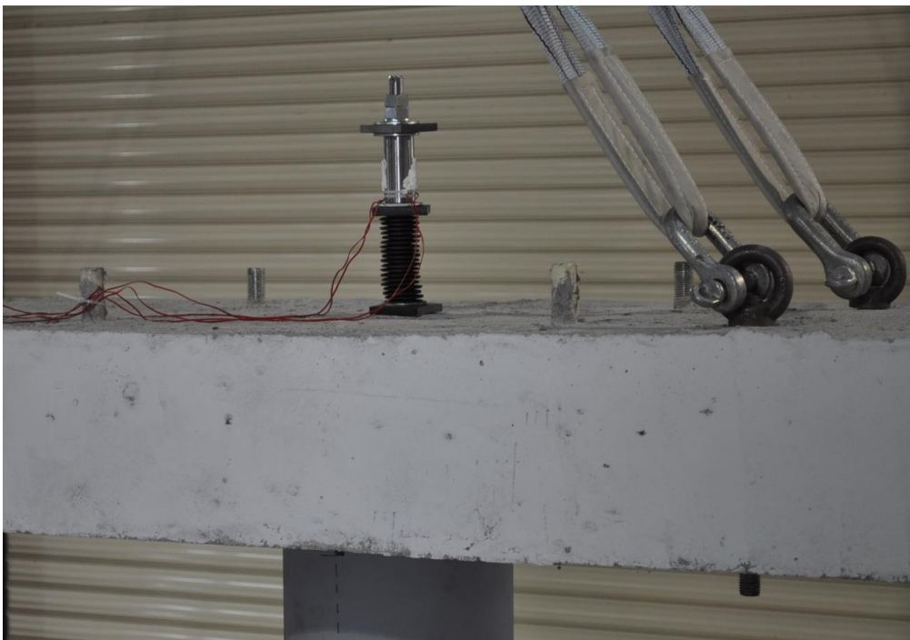
Σχήμα 5.1.6. Αγκύρωση καλωδίου προέντασης, διερχόμενο από το κοντό βάρη, στο πάνω μέρος του καταστρώματος, μέσω ελατηρίων τύπου belleville springs και δυναμοκυψέλης.
