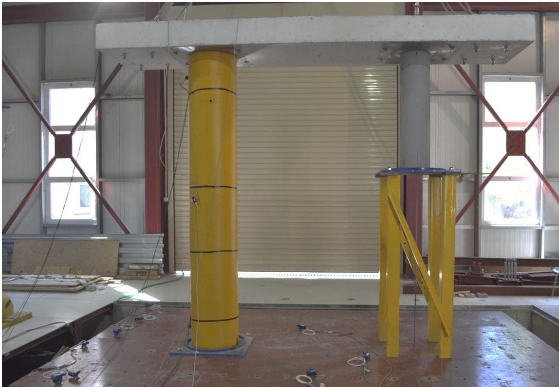
Σχήμα 5.1.1. Πειραματική διάταξη του λικνιζόμενου πλαισίου με ανισοϋπή βάθρα.
