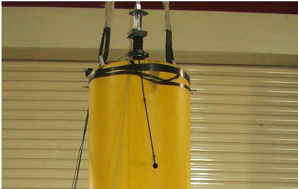
Σχήμα 1.2.22: Αγκύρωση καλωδίου προέντασης στην κορυφή του βάρου ( EA/m_c g=100 ) και διάταξη της δυναμοκυψέλης μαζί με τα ελατήρια.
