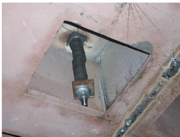
Σχήμα 1.2.21: Αγκύρωση καλωδίου προέντασης κάτω από την σεισμική τράπεζα ( EA/m_c g=25 ) και διάταξη των ελατηρίων τύπου belleville springs .
